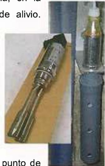
Para evitar, en lo posible, la incrustación de elementos flotantes, como trapos, en las paletas, se incorporará al detector un tubo de PVC con
