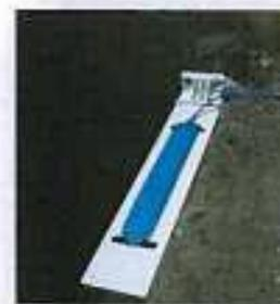
**Otro sistema** que se ha testeado y ha dado **resultados aceptables** son los **detectores de nivel ultrasónico**. Concretamente aunque se han realizado pruebas con la sonda SICK UM18- 218161101, existen en el mercado sondas similares de otros fabricantes de referencia en instrumentación industrial. Al igual que las sondas de nivel ultrasónico la
